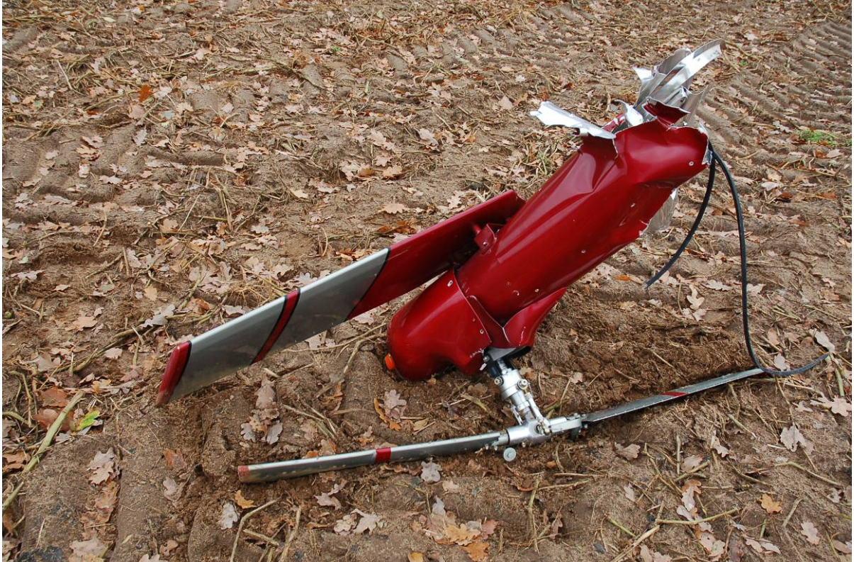
Abgetrenntes Heck mit Heckrotor und Antriebsriemen
