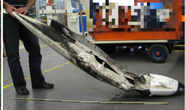
GFK-Verkleidung, hier nachträglich auf den Tip Tank aufgesetzt
