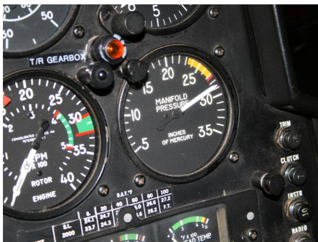
Ladedruckanzeige bei abgestelltem Triebwerk
