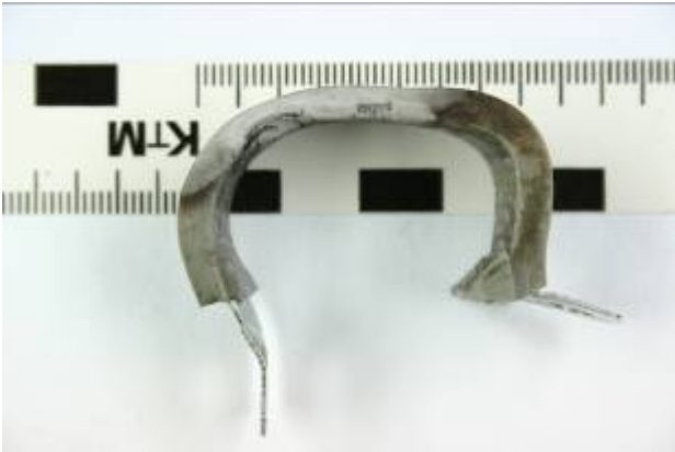
Foto oben und unten: defekte Kabelschelle
