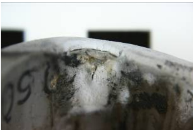
Foto oben und unten: defekte Kabelschelle
