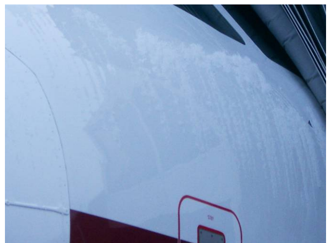
Schnee und Eisreste am Rumpfbug unterhalb der Cockpitscheiben nach der Landung in Frankfurt. Fotos: BFU
