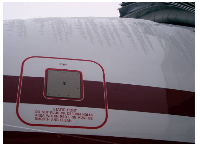
Nach der Landung in Frankfurt war noch Eis auf dem Rumpfbug über den Static Ports und den Pitot Probes zu erkennen.
