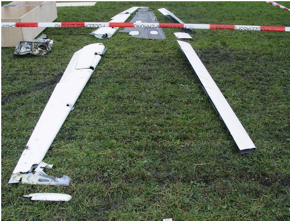
Abbildung 4: Vor der Unfallstelle gefundene Teile des Höhenleitwerks
