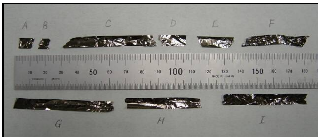
Abbildung 7: Teile des beschädigten Magnetbandes
