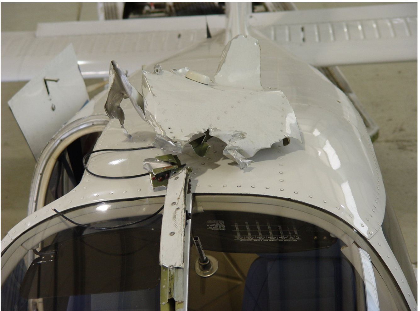
Das aufgefundene zerstörte Cockpitdach von Flugzeug 2, ausgelegt auf dem intakten Cockpitdach von Flugzeug 1
