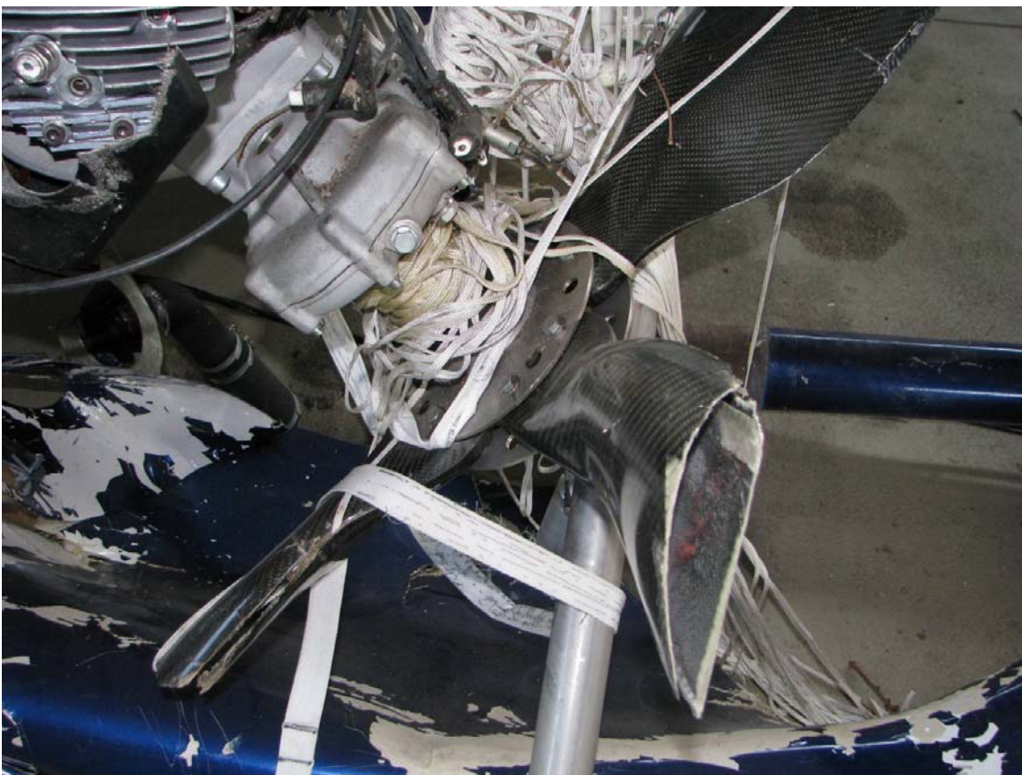
Anlage 4: Beschädigter Propeller mit von Fallschirmleinen umwickelter Propellernabe.
