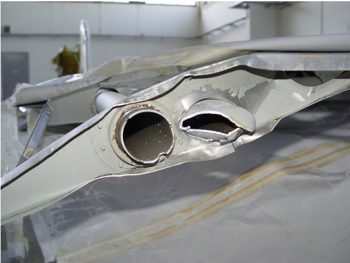
Anlage 3: Dieses Detailbild zeigt rechts den hinteren Holm und links das Querruderansteuerrohr; umschlossen von Rippe 5.
