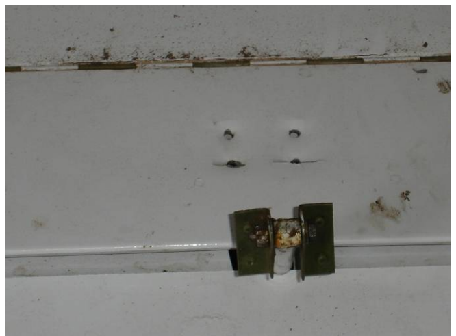
Bild 3: eingeklemmte Anlenkung der rechten Bremsklappe
