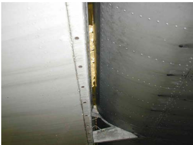
Vereiste Rückstände zwischen Flosse und Ruder des Höhenleitwerks bei einer BAe 146
