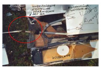
Wie alle L' Hotellierverschlüsse war auch dieser mit einer Sicherungsnadel gesichert. Er diente der Steuerstangenverbindung zwischen dem linken Innenund Außenflügelbereich zur Ansteuerung des linken Querruders.
