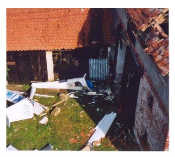
Der erste Aufprall erfolgte dabei auf dem Dach eines Gebäudes. Er gelangte danach in Rückenlage und fiel in den Hofbereich des Anwesens. Der Rumpf und die Tragflächen sind beim Aufprall mehrfach zerbrochen worden und der Cockpitbereich wurde völlig zertrümmert. Das Leitwerk wurde am Rumpfübergang abgebrochen.
