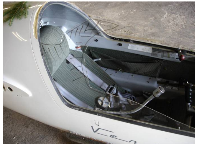
Abb. 7 Ventus: Rest der zerstörten Haubenverglasung
