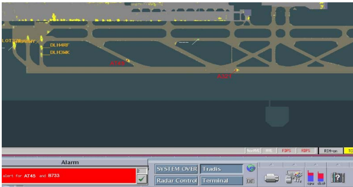
Bild 8: Radaraufzeichnung 21:39:09 Uhr. RIM-Alarmierung zwischen der AT 45/B 733. Die B 733 befand sich im kurzen Endanflug und wurde kurze Zeit später auf dem Rollfeldradar sichtbar.
