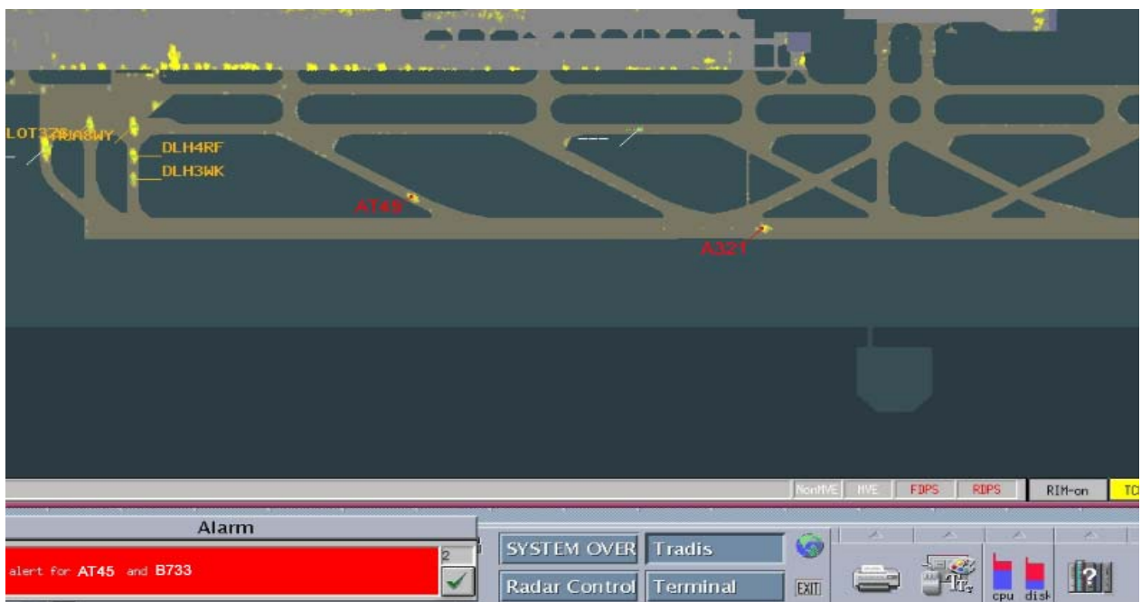
Bild 14: Radaraufzeichnung 21:39:09 Uhr. RIM Alarmierung zwischen der AT 45 / B 733. Die B 733 befand sich im kurzen Endanflug und wurde kurze Zeit später auf dem Rollfeldradar sichtbar.
