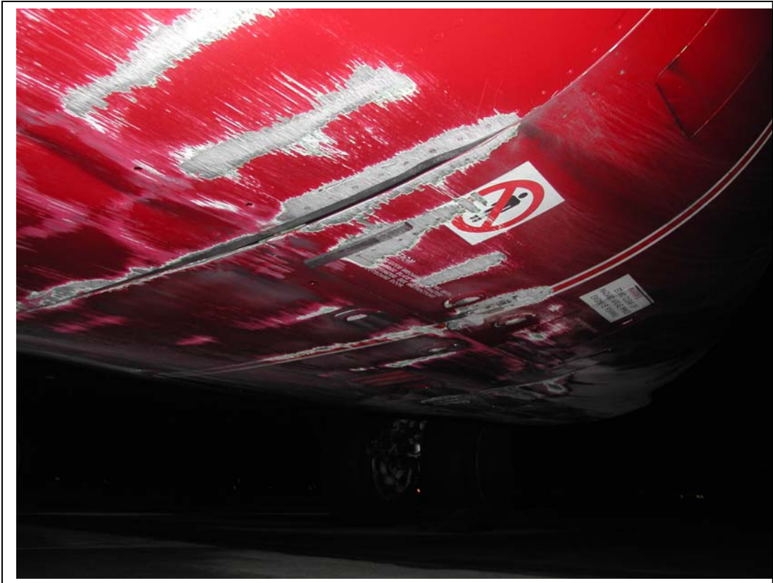
Schleifspuren am linken Triebwerk
