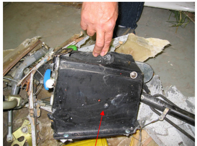
Instrumentenpilz-Bauteil mit Verschraubung zur Befestigung von Trimmgewichten
