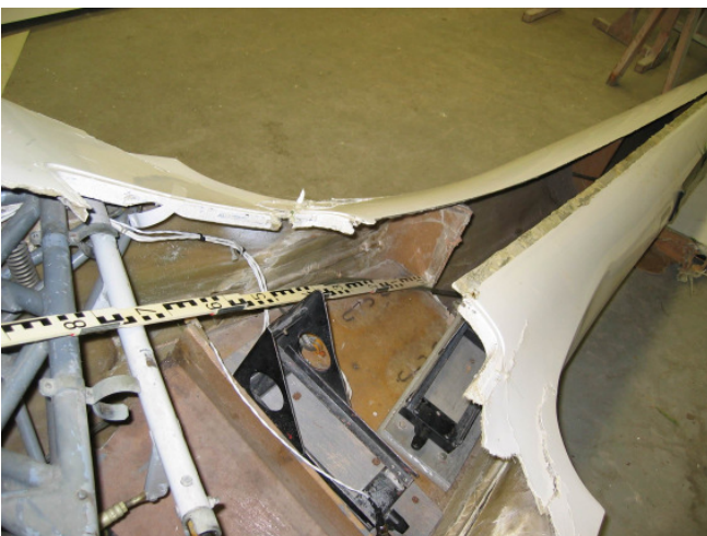
Gepäckfach mit zwei fest montierten Batteriehalterungen
