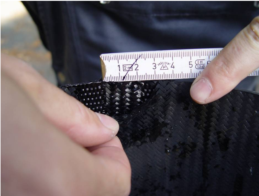
Linke Rumpfhälfte: Unterbrechung der UD-Lage ca. 20 mm
