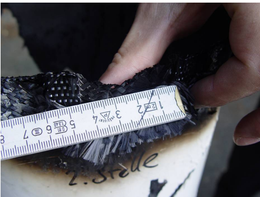
Rechte Rumpfhälfte: Unterbrechung der UD-Lage ca. 45 mm
