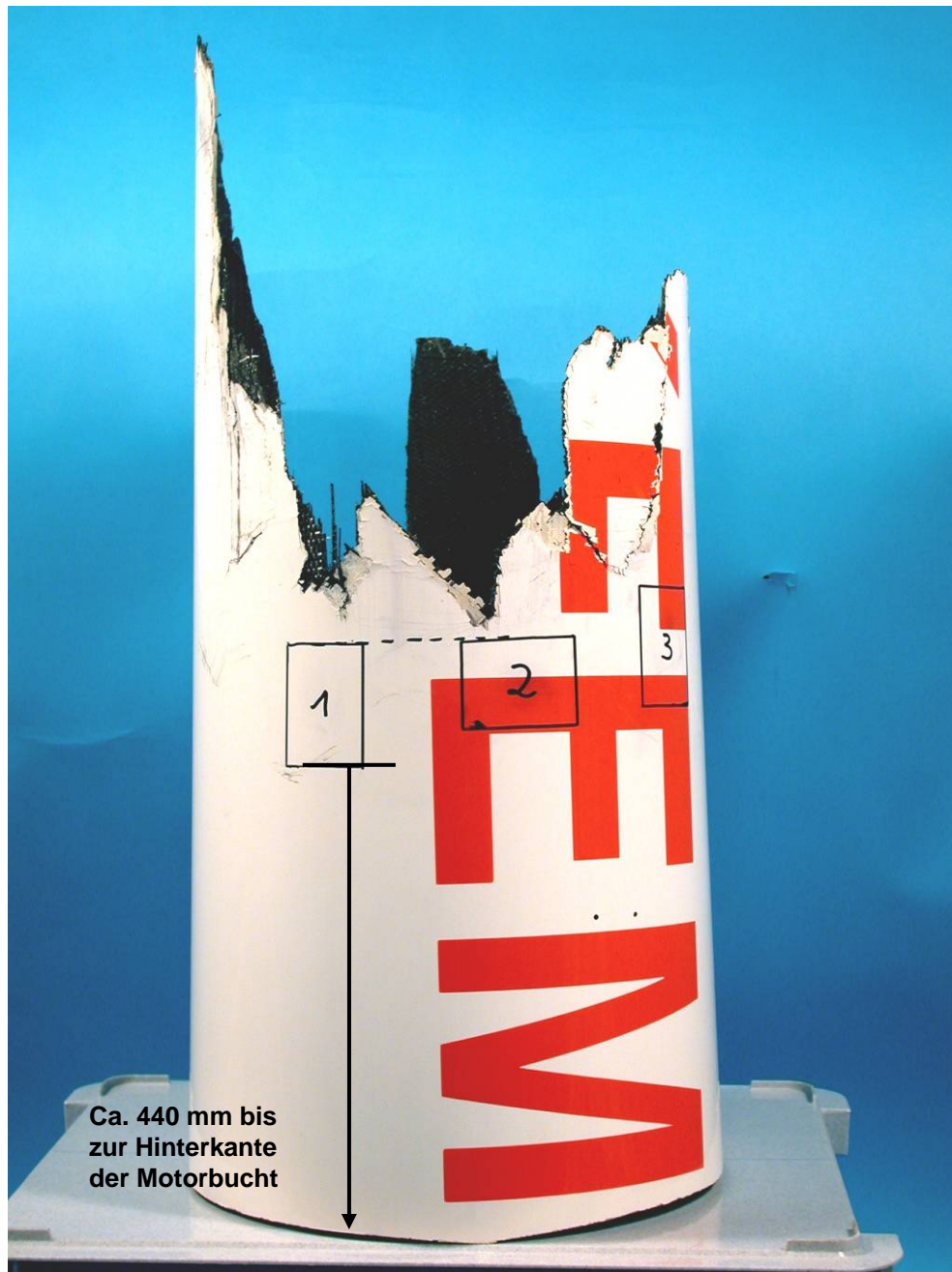
Bruchstück mit Markierungen von drei der vier Quadranten (Nr. 4 befindet sich auf der Oberseite)
