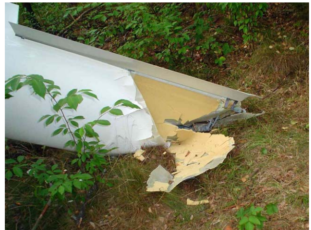
Bild 3: Bruchstelle der linken Tragfläche
