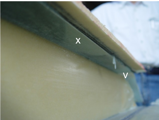
Bild 5: Fehlverklebung (x) und Überschuss (v) an Klebstoff
