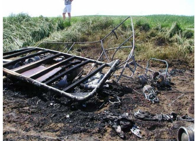
Beim weiteren Umkippen unterhalb der Böschungskante prallte die Brenneranlage mit großer Wucht auf den Boden und alle Insassen des Ballonkorbes waren dadurch vom Ballonkorb überdeckt. Es entstand ein Feuer unter dem Ballonkorb und trotz des Einsatzes der Feuerwehr, die nach kurzer Zeit am Unfallort aktiv wurde, konnte ein völliges Abbrennen des Ballonkorbes nicht verhindert werden.
