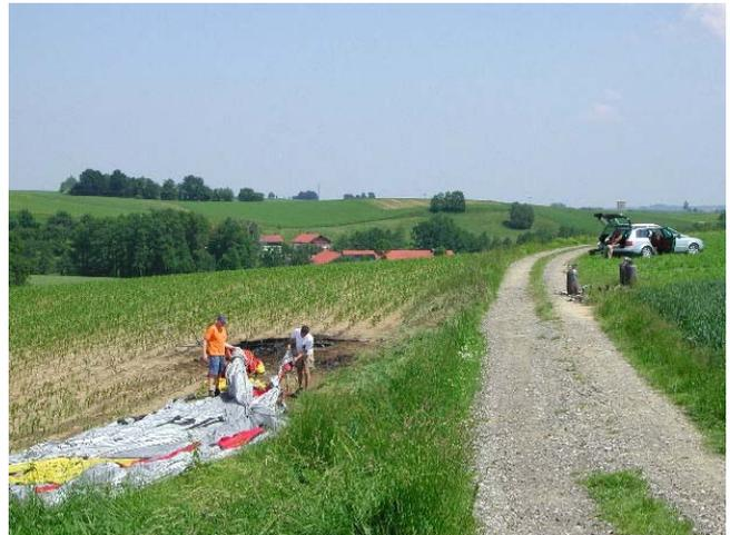
Beim weiteren Entleeren und Ablegen der Ballonhülle kippte der Ballonkorb weiter bis auf die Brenneranlage und alle Insassen waren nun vom Ballonkorb eingeschlossen. In dieser Lage entstand unter dem Ballonkorb durch austretendes Propangas, welches sich entzündete, ein Feuer im Bereich der Brenneranlage. Dabei wurden 5 Passagiere und die Ballonführerin verletzt. Es gelang den Insassen sich selbst aus dem umgestürzten Ballonkorb zu befreien und den bren-
