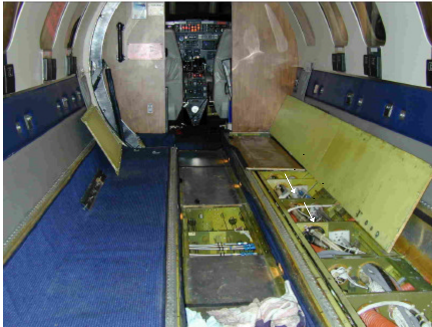
Kabine des Flugzeuges SA 227 AC Rechter Unterflur mit Hydraulikleitungen und Kabelbäumen Positionen A und B werden weiter unten beschrieben
