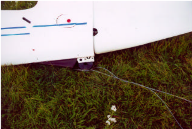
Bild 1: am Sporn verfangenes Schleppseil
