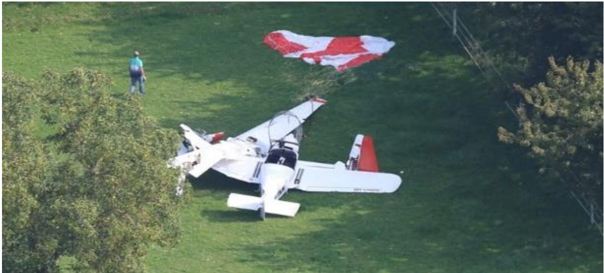
Abb. 42: Rettungsgerätauslösung nach Kollision von UL und Segelflugzeug im Endanflug
