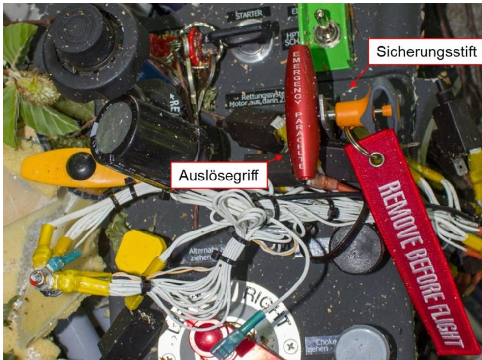
Abb. 41: Mit Stift gesichertes Rettungsgerät bei einem verunfallten UL
