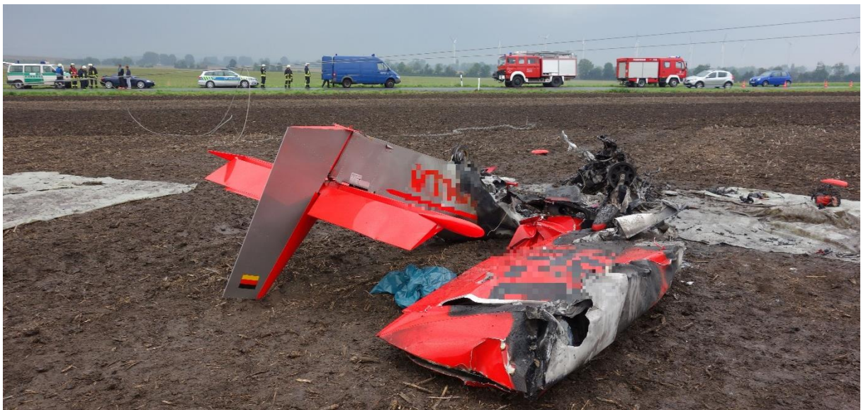
Abb. 26: Hindernisberührung eines UL mit einer 20-kV-Überlandleitung in etwa 9 m Höhe, ein Leitungsmast war abgebrochen und ein weiterer beschädigt (herunterhängende Kabel im Hintergrund) Quelle: BFU
