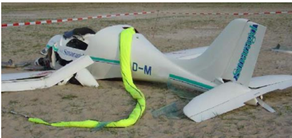
Abb. 44: Fehlöffnung eines Rettungsgeräts
