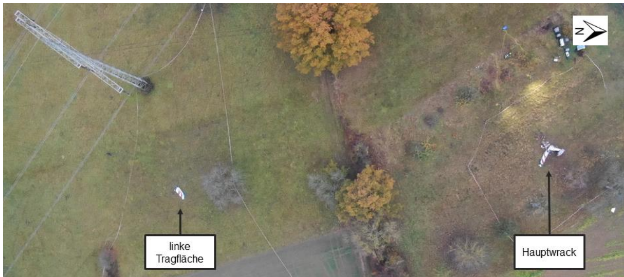
Abb. 27: Tragwerksbruch eines Ultraleichtflugzeuges im Fluge
