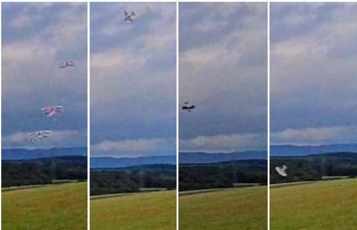
Abb. 25: Fotosequenzen eines tödlichen Unfalls mit Kontrollverlust (Abkippen und Trudeln) nach hochgezogener Umkehrkurve in niedriger Höhe Quelle: Überwachungskamera Flugplatz
