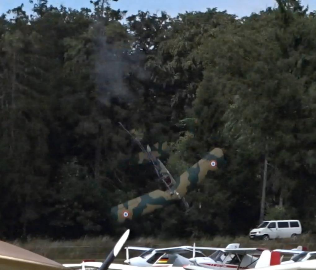
Abb. 43: Auslösung des Rettungsgeräts in geringer Höhe
