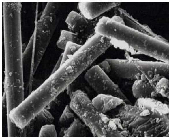
Abb. 45: Verbrannte Kohlefaser (mikroskopische Aufnahme)
