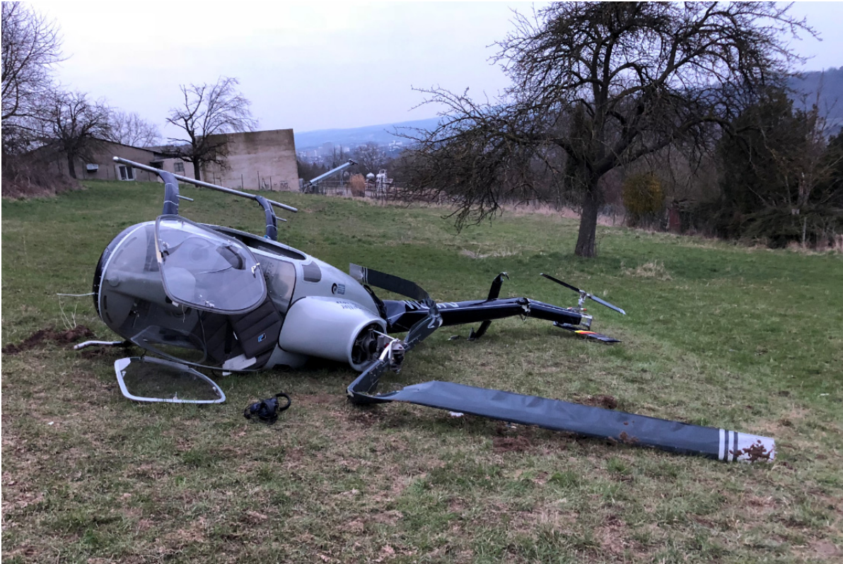
Abb. 8: Unfall nach Autorotationslandung eines Hubschraubers Rotorway Exec 162F
