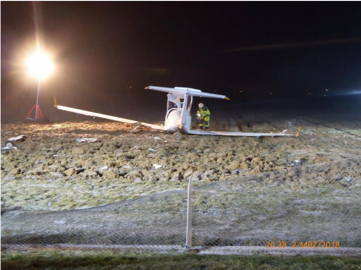
Abb. 5: Beschädigung des Flughafenzauns und Endlage des Flugzeuges
