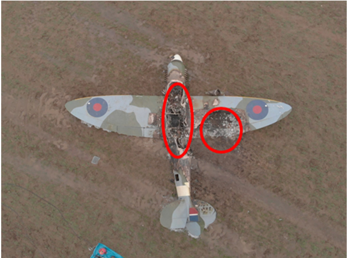
Hauptwrack; Hauptbrandbereiche wurden markiert
