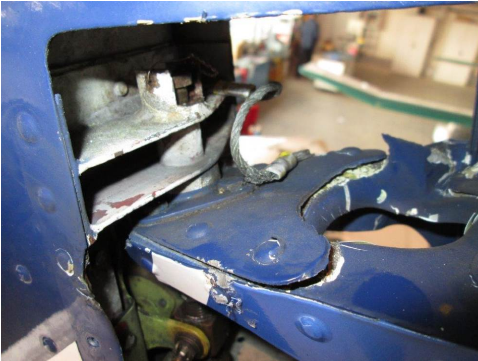
Abbildung 3: Beschädigtes mittleres Seitenruderscharnier
