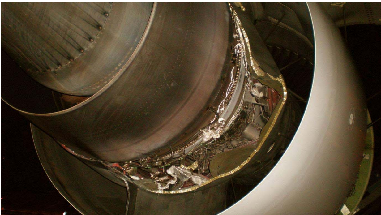
Beschädigter Thrust Reverser
