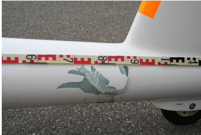
Beschädigung Rumpfröhre DG 300
