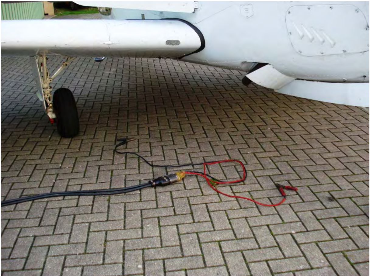
Starterkabel mit Verlängerung für den direkten Anschluss an die bordeigene Batterie
