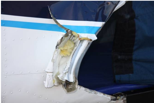
Beschädigung im Bereich des Ausstieges
