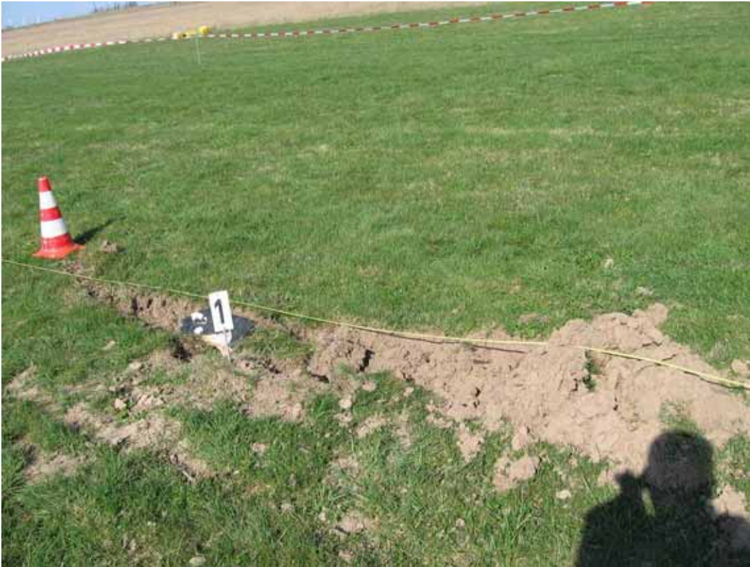
Propellermarken und Erdauswurf in 7 Meter Abstand zum Wrack
