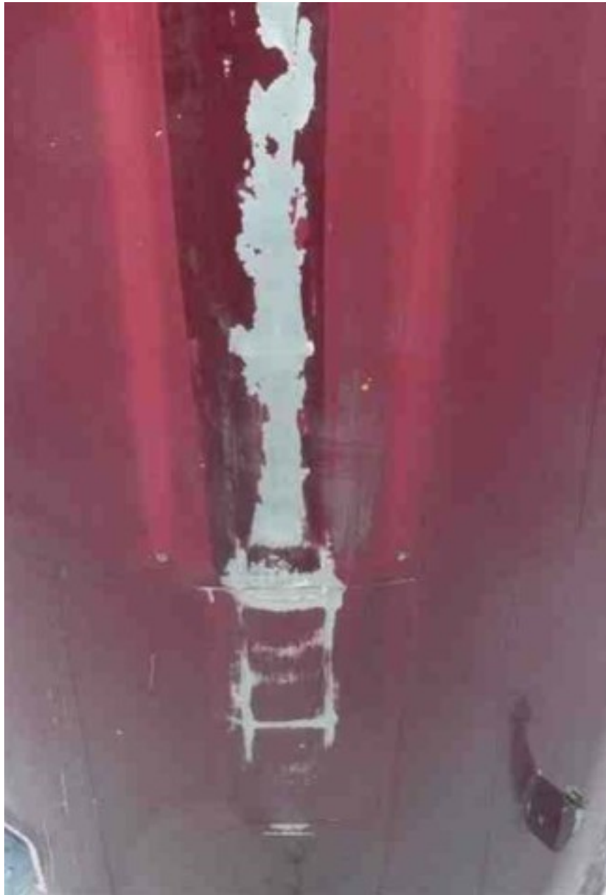
Die beschädigte Rumpfunterseite in Flugrichtung gesehen
