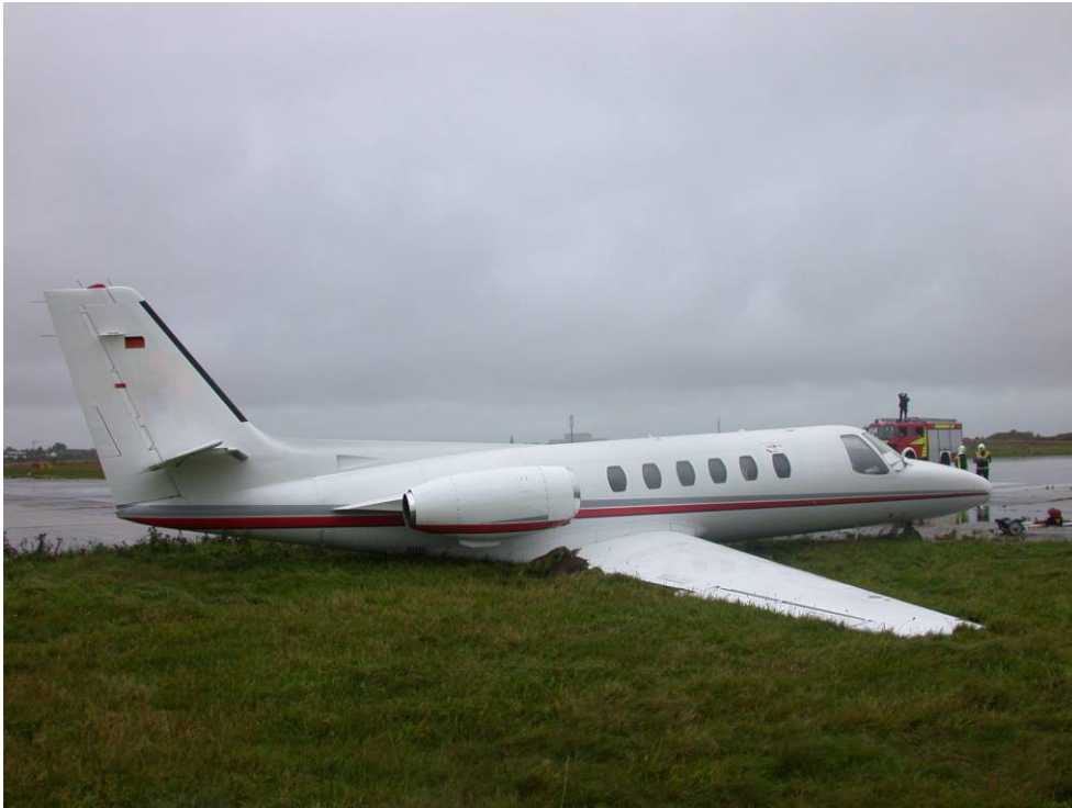
Bild 3: Die beschädigte rechte Tragfläche über dem eingeknickten rechten Hauptfahrwerk
