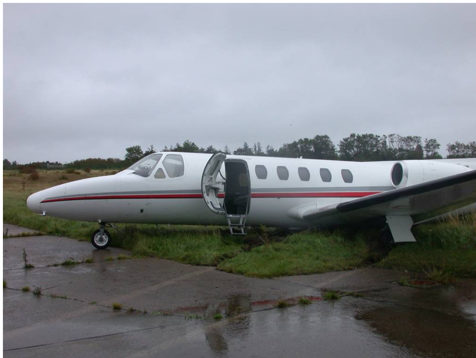
Bild 2: Das in den Boden eingesunkene Hauptfahrwerk
