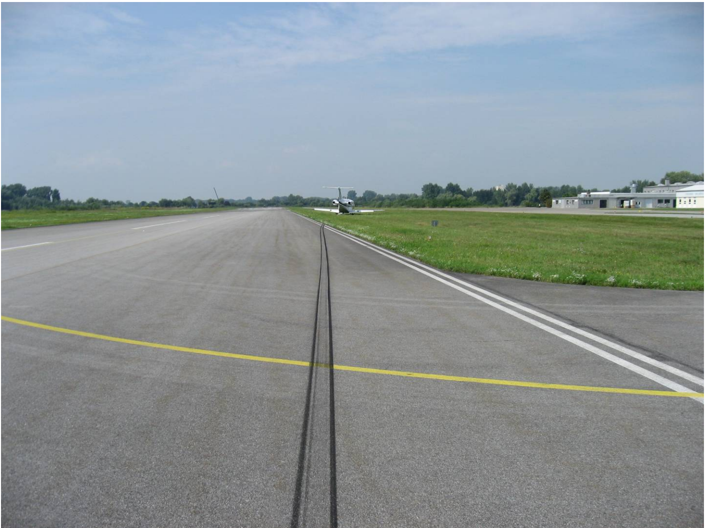
Luftfahrzeug rechts neben der Landebahn mit der Spur des rechten Fahrwerkes
