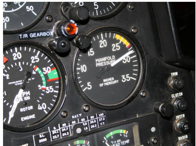
Ladedruckanzeige bei abgestelltem Triebwerk
