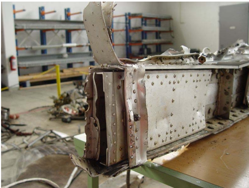
Bruchstelle am Hauptholm des linken Tragflügels
