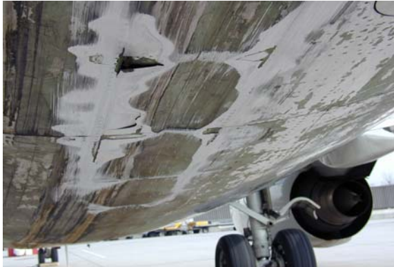
Beschädigungen an der Rumpfunterseite
