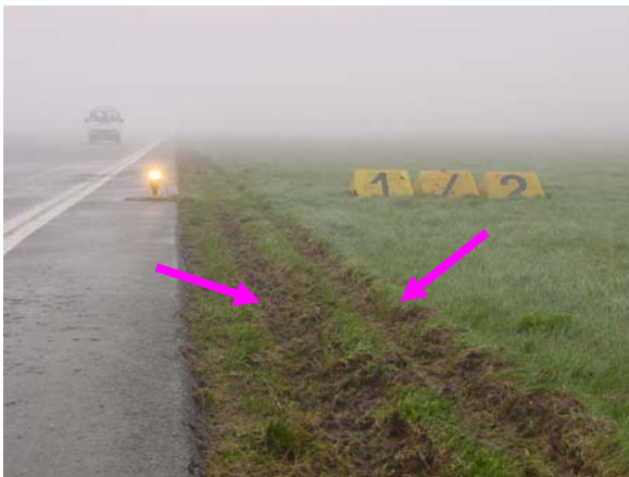
Rollspur des linken Hauptfahrwerks
