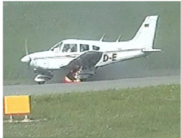
Bild 1: Kurz nach Beginn des Brandes, an beiden Fahrwerksbeinen sind helle Flammen erkennbar
