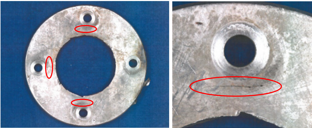
Schwingungsrisse entlang des Hauptbruchs und im Bereich der Befestigungsschrauben
