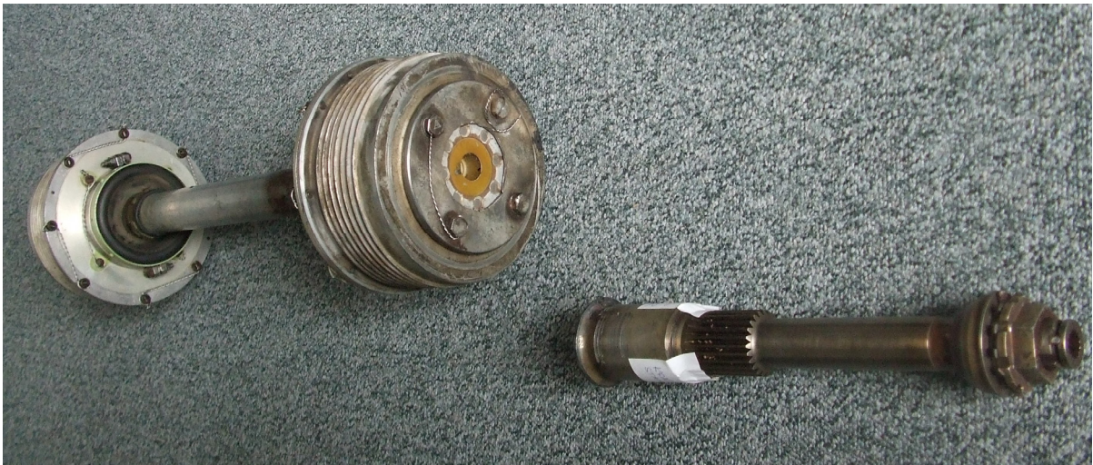
Hauptantriebswelle mit abgebrochenem Triebwerkausgangsschaft
