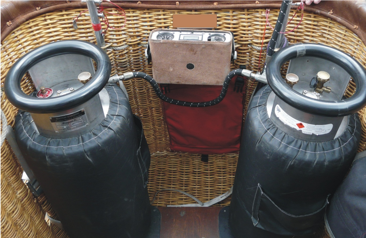
Gasbehälter mit montierter Gasverbindungsleitung
