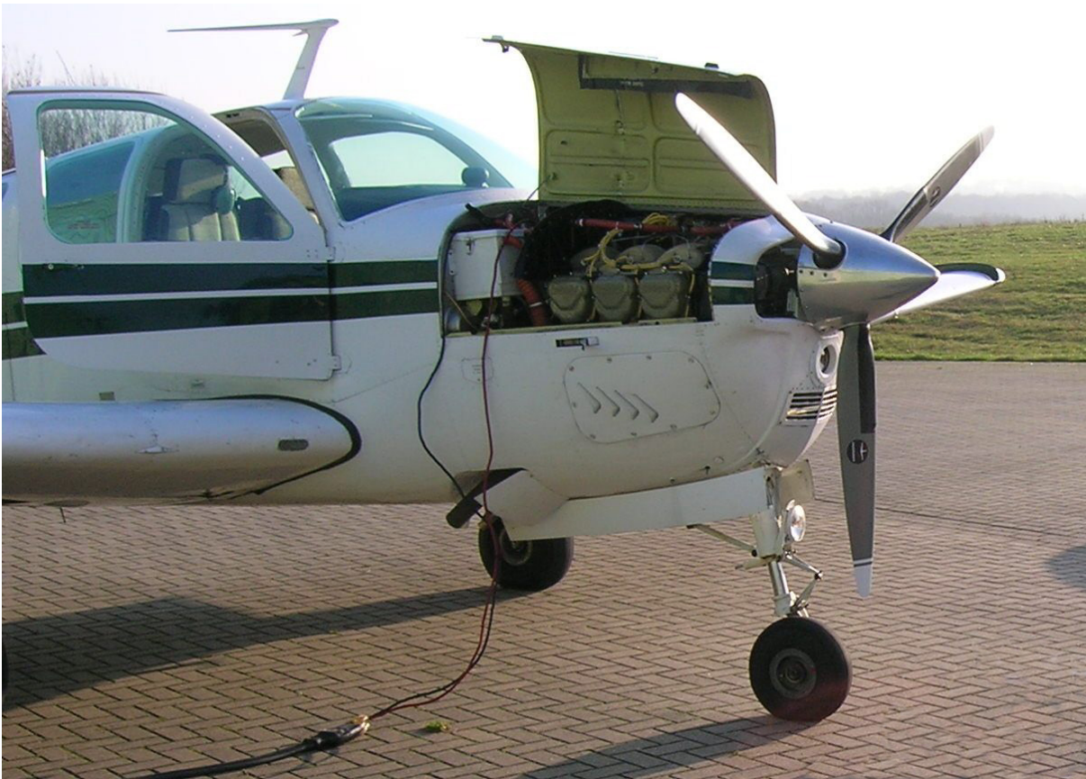
Starterkabel mit Verlängerung für die Überbrückung der Bordbatterie
