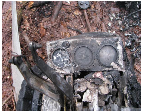
Mittelkonsole mit Leistungshebeln und Anzeigen
