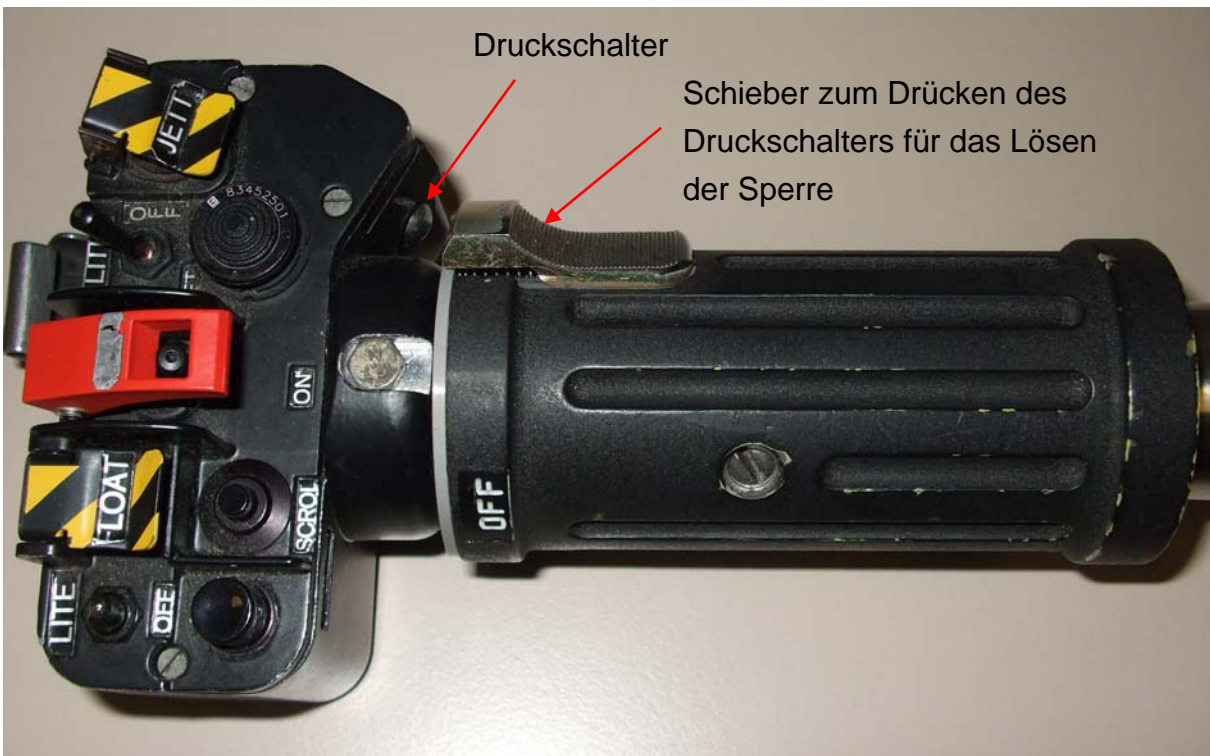
Detailaufnahmen der Stoppvorrichtung des Drehgasgriffs
