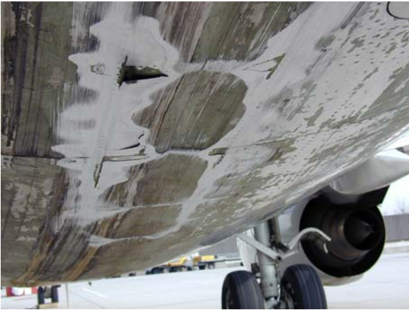
Beschädigungen an der Rumpfunterseite
