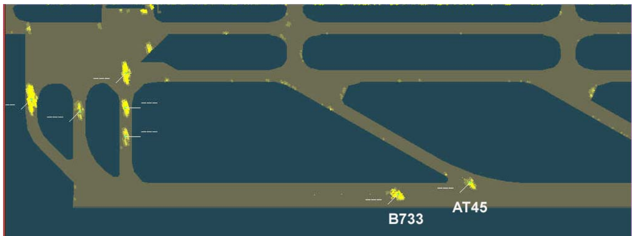
Bild 5: Radaraufzeichnung 21:39:24 Uhr: Die B 733 nach dem Aufsetzen. Die Besatzung bemerkte, dass die AT 45 auf die Piste rollte. Die AT 45 war noch ca. 25 m von der Mittellinie entfernt.
