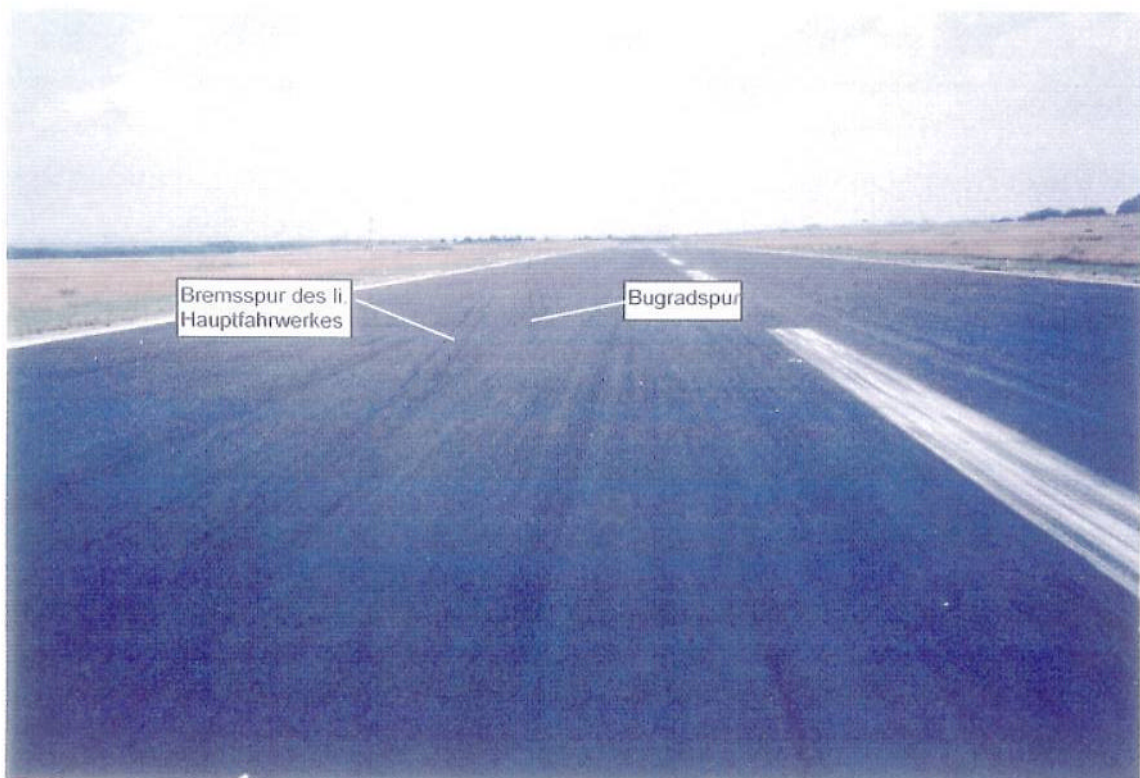
Die Bremsspur des linken Hauptfahrwerkes setzt zuerst ein, die Bugradspur setzt erst ein, als mit der Bugradlenkung gegengesteuert wird.
