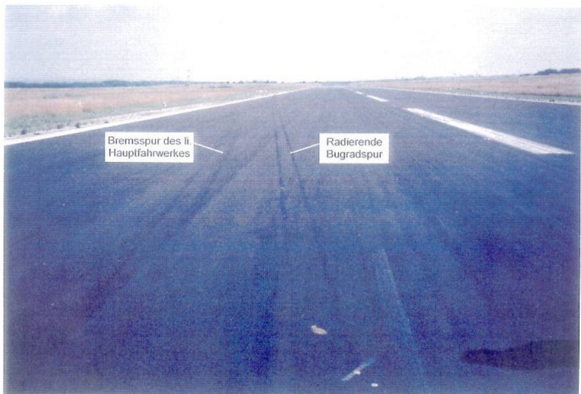
Deutlich sichtbar die Bremsspur des linken Hauptfahrwerkes und die radierende Bugradspur, dagegen fehlt die Bremsspur des rechten
