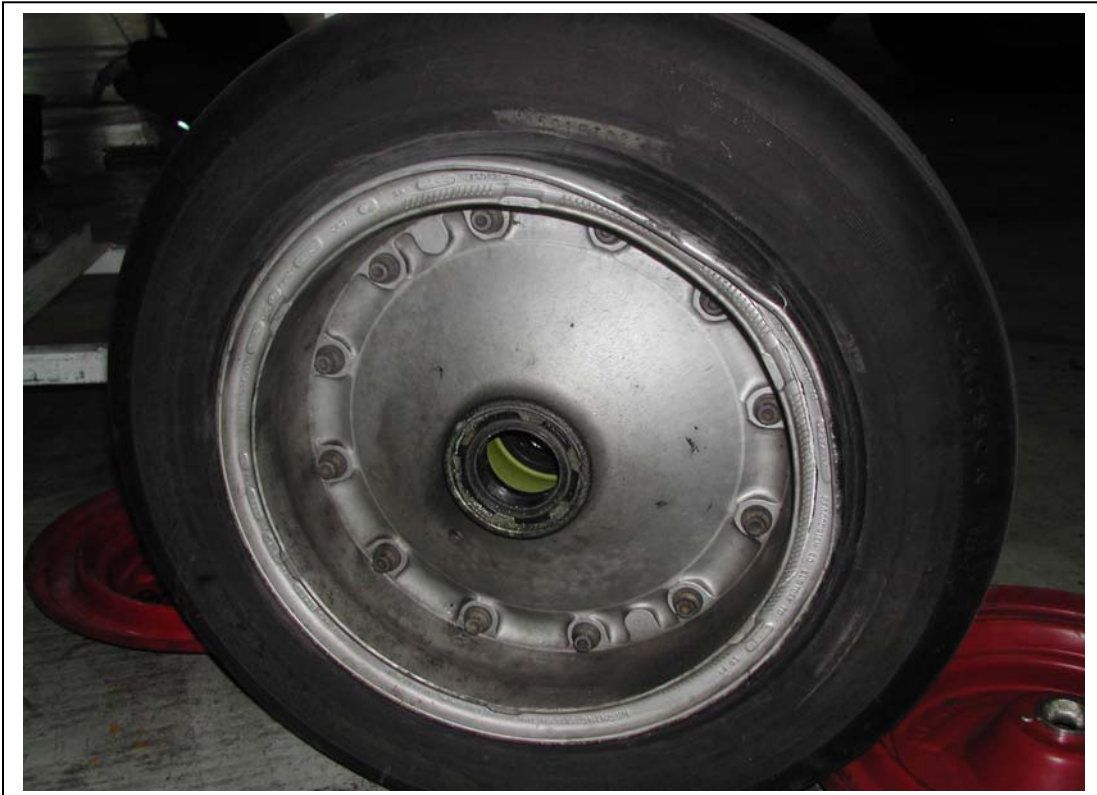
Beschädigte Felge des linken Bugfahrwerksrades
