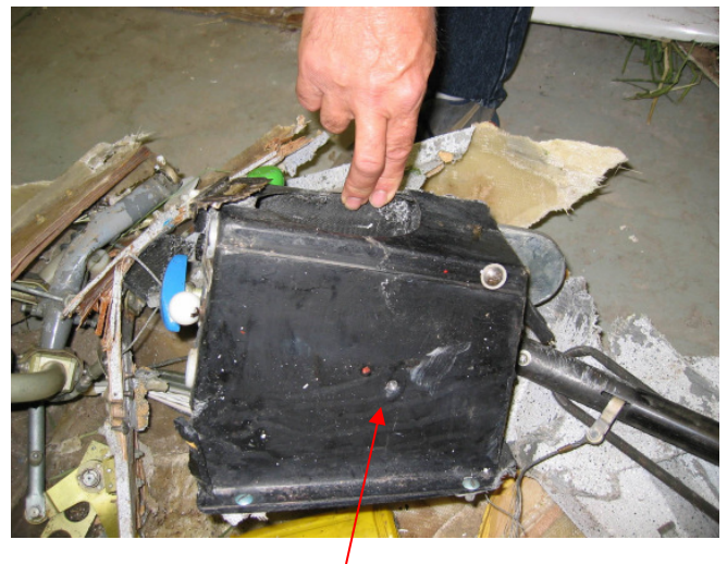
Instrumentenpils-Bauteil mit Verschraubung zur Befestigung von Trimmgewichten
