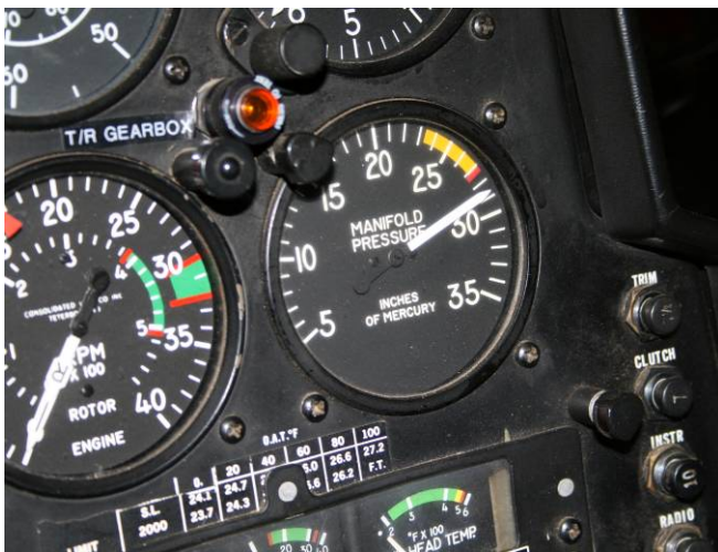
Ladedruckanzeige bei abgestelltem Triebwerk
