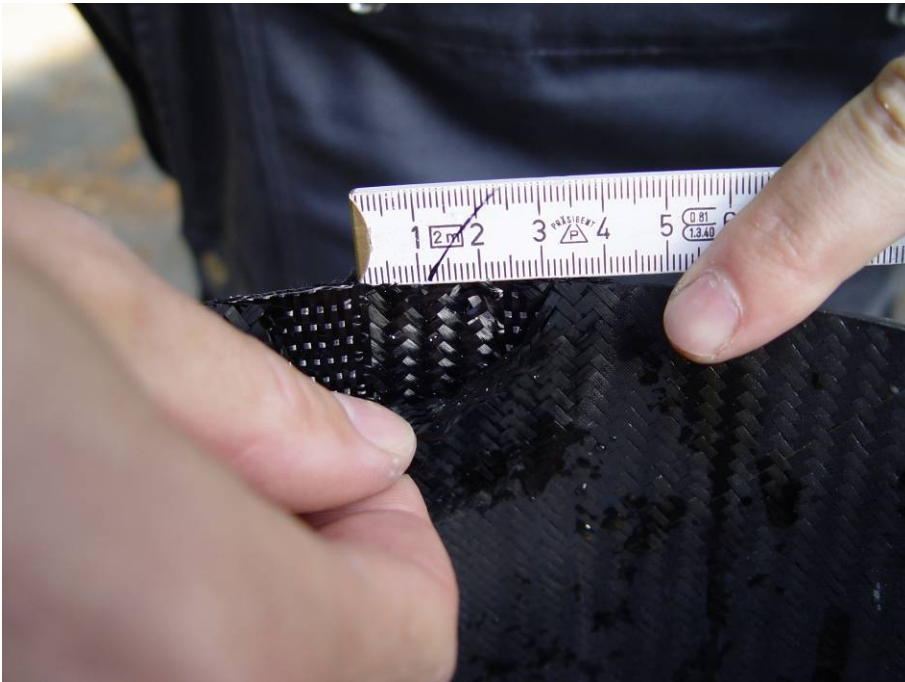
Linke Rumpfhälfte: Unterbrechung der UD-Lage ca. 20 mm
