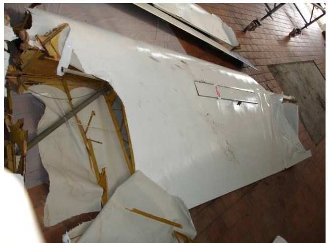
Bild 2: Ansicht der Störklappe am rechten Tragflügel mit eingeklemmter, abgetrennter Anlenkung
