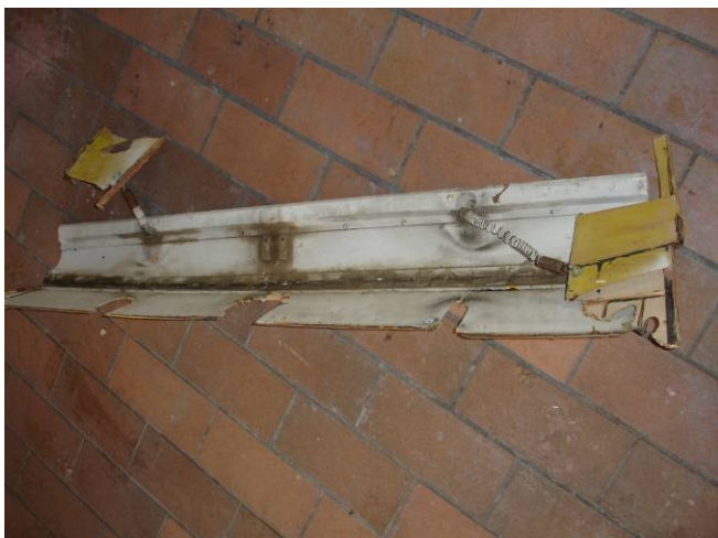
Bild 4: ausgebaute Bremsklappe mit überdehnten Rückholfedern
