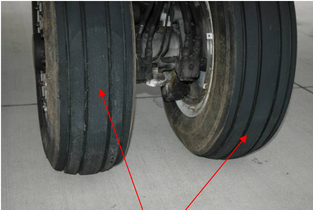
Spuren von Aquaplaning an den Reifen
