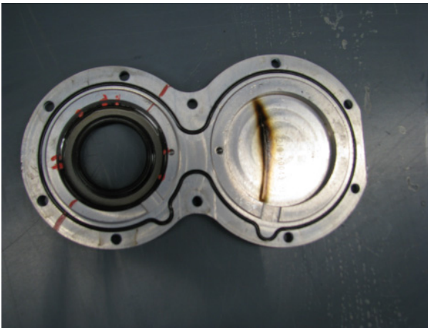
Innenseite Abschlussdeckel mit Schleifspur
